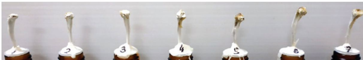
Рис.3. Фиксация эпифизов большеберцовой костей крыс в форме с костным цементом СЕМЕХ
