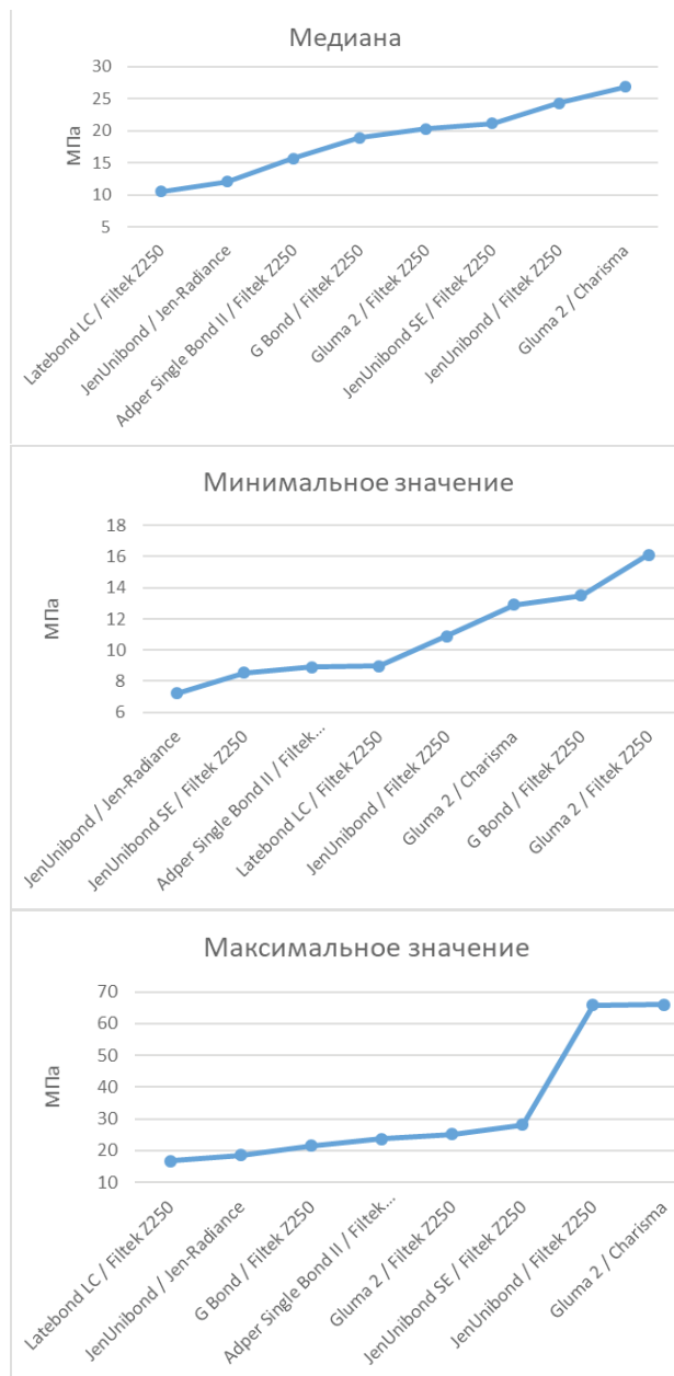
Рис. 2. Средние величины силы адгезии фотокомпозита к твердым тканям зуба у различных комбинаций адгезивной системы и материала
